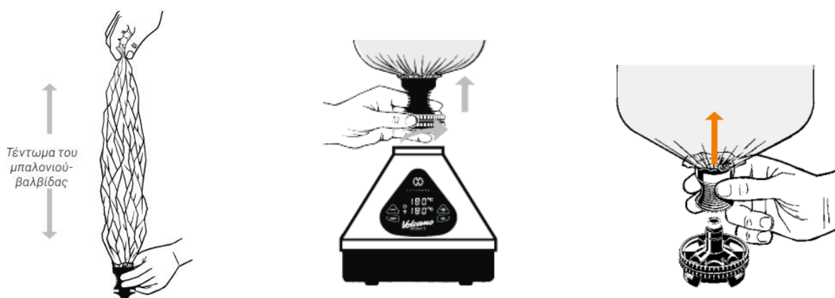
Τεντωμένο μπαλόνη-βαλβίδα, απομάκρυνση του μπαλονιού από την συσκευή και αφαίρεση από τον θάλαμο πλήρωσης
