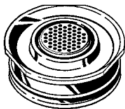
Κάψουλα δοσολογίας τοποθετημένη μέσα στον θάλαμο πλήρωσης
